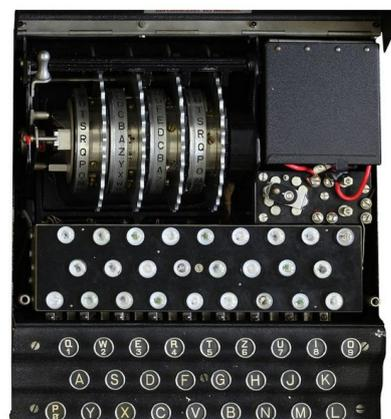
Voici un exemple avec uniquement 4 chiffres au lieu des 26 lettres pour simplifier. Le chiffre à coder est à droite (par exemple, 0). Les sorties du rotor 1 sont reliées avec les entrées du rotor 2. Les sorties du rotor 2 sont reliées aux entrées du rotor 3. Les sorties du rotor 3 sont reliées à un réflecteur qui, lui aussi, relie différemment les chiffres et renvoie sur le rotor 2 puis le rotor 1.
